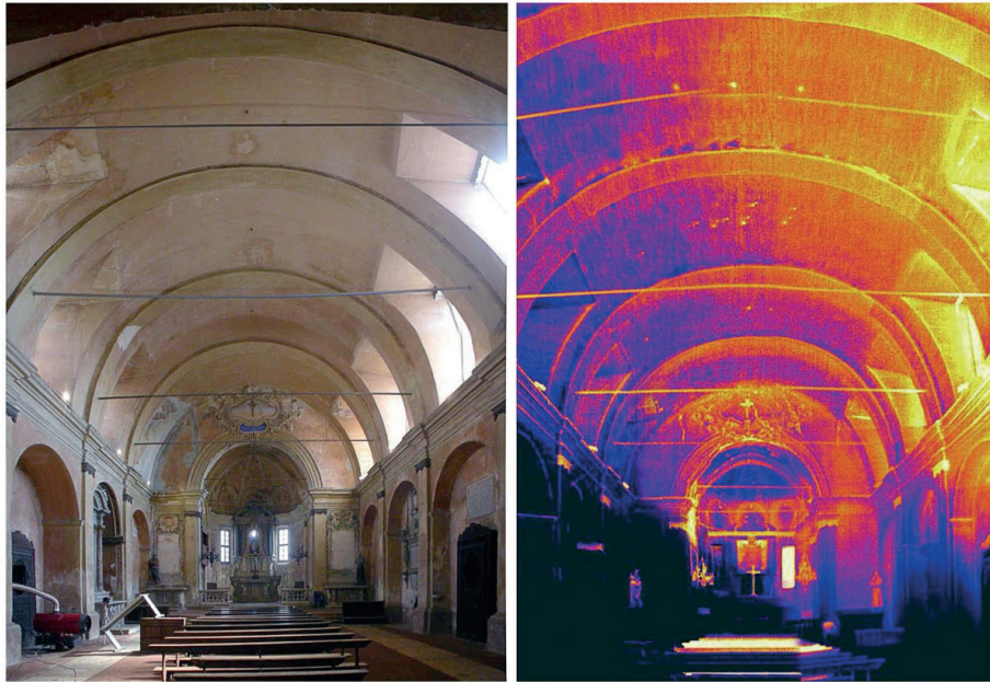
CHIESA DELLA DISCIPLINA: RILIEVO TERMOGRAFICO DELLA NAVATA E DEL PRESBITERIO TINT 13,4°C; URINT 43,5% TEST 11,8°C; UREST 19,0% RANGE 13,5°C – 17,5°C
